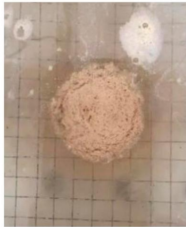
Figura 4. Proceso de desintegración sin tratamiento (desintegración completa).
