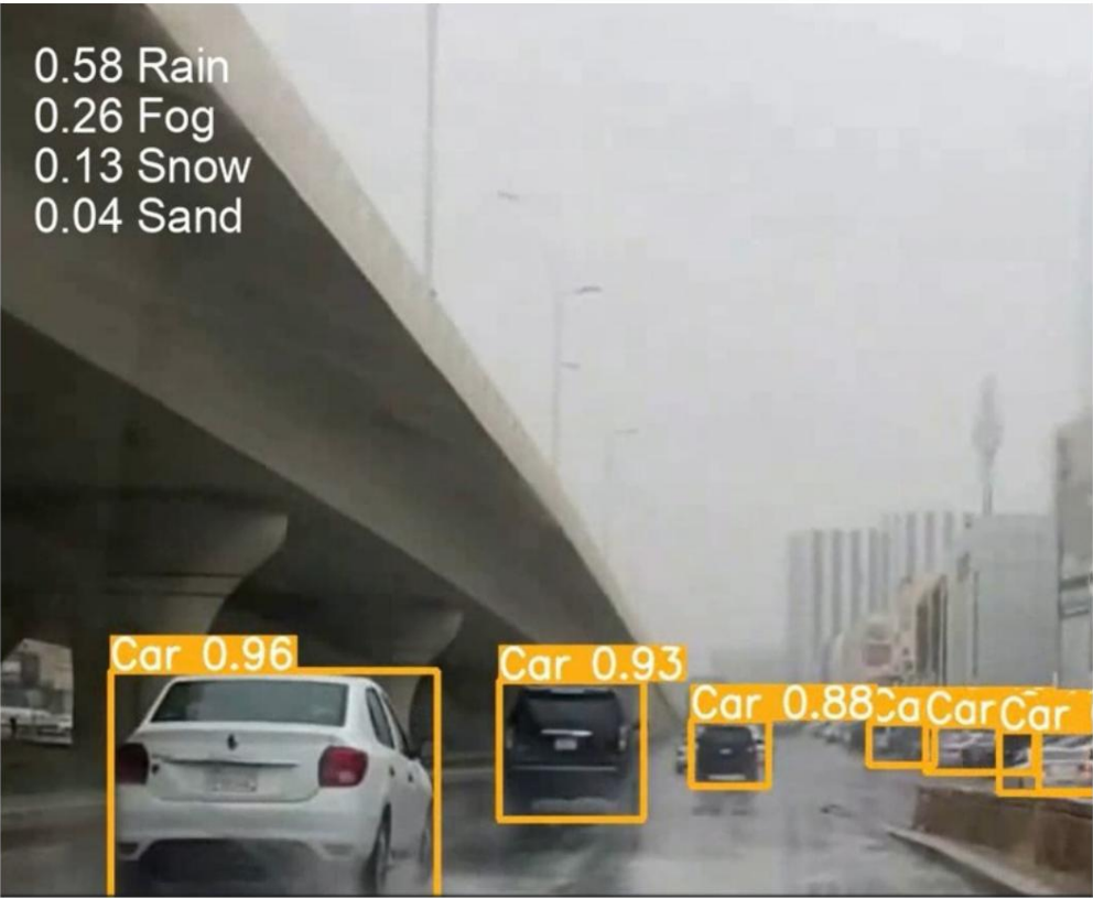
Рисунок 14. Модель успешно классифицировала дождливую погоду и обнаружила объекты на сцене. Рисунок 14. Модель успешно классифицировала дождливую погоду и обнаружила объекты на сцене. 8. Обсуждение
