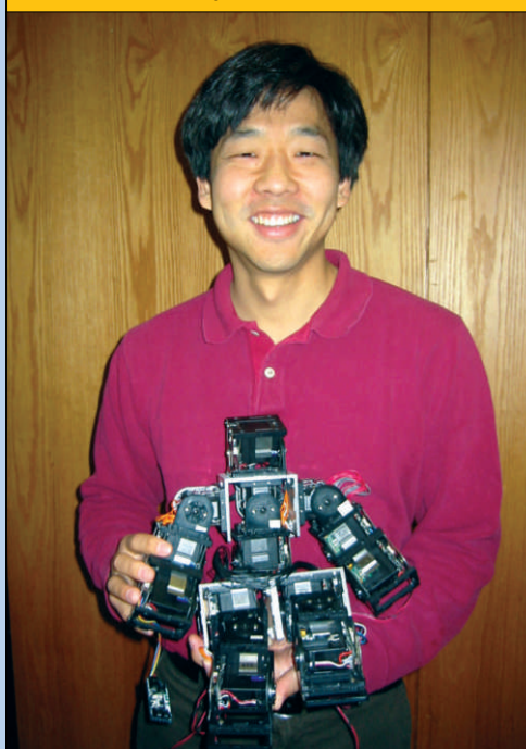
Исследователь Марк Йим показывает ходячего двуногого из модулей G1v5.
