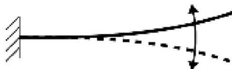
Abbildung 6. Kragträger, der freier Schwingung ausgesetzt ist (senkrecht zur Blattsehne).
