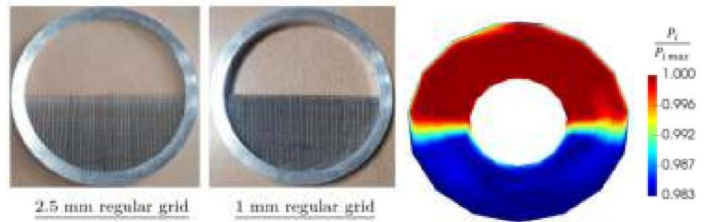
Abbildung 7. Verzerrungsgitter und Beispiel eines gemessenen Gesamtdruckmusters.
