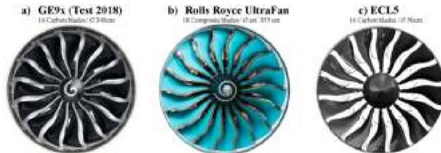
Abbildung 2. Moderne industrielle Verbundventilatoren mit niedriger Geschwindigkeit und offener Testfall ECL5/CATANA (CAD).
