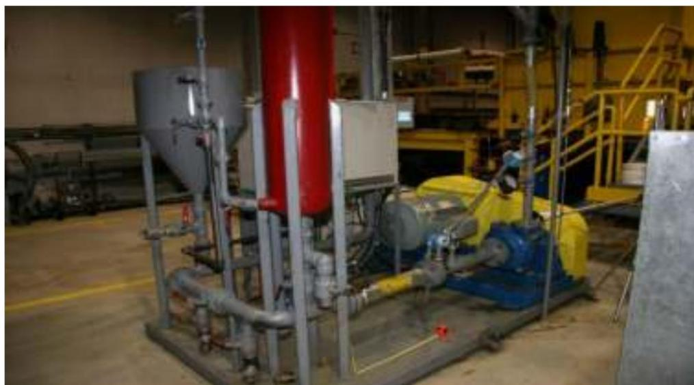
Abbildung 4. Experimentelles System einer Kreiselpumpe.
