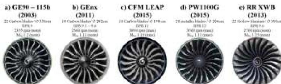
Abbildung 1. Auswahl etablierter moderner Triebwerke mit ultrahohem Nebenstromverhältnis.
