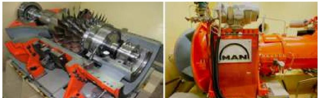
Abbildung 2. Neuer 3-stufiger Axialkompressor (links: während der Installation, rechts: Endmontage).
