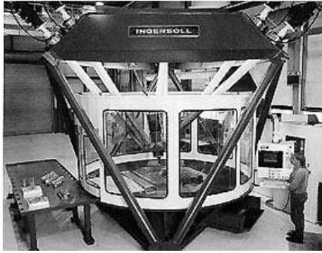
(a) Eine Werkzeugmaschine basierend auf der Stewart-Plattform (Ingersoll Rand)6
