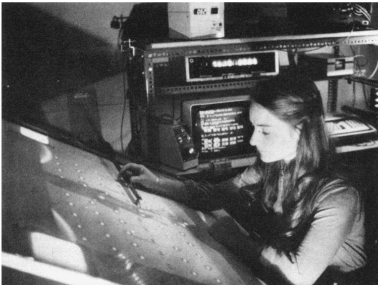
Abbildung 3.11 Typische Anordnung für die Mikrocomputer-Digitalisierung von Datenkoordinaten aus Filmfilm. Mit dem Fußpedal kann der Bediener Koordinatendaten mit einer Geschwindigkeit von etwa 10 Koordinatenpaaren pro Minute an den Computer übertragen. Der Digitalisierungsfehler beträgt etwa 1 mm rms, wenn die Kamera 4 m vom Motiv entfernt ist.
