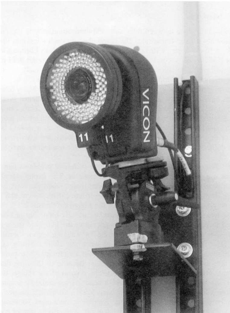
Abbildung 3.12 Typische Infrarot-Fernsehkamera, die fest in einem klinischen Ganglabor montiert ist. Die Infrarotlichter bilden eine „Donut“-Form um das Objektiv herum und werden bei jedem Bild für kurze Zeit gepulst, um das Bild vor dem Scannen einzufrieren. (Mit freundlicher Genehmigung des Gait Analysis Laboratory, Connecticut Children's Medical Center, Hartford, CT.)
