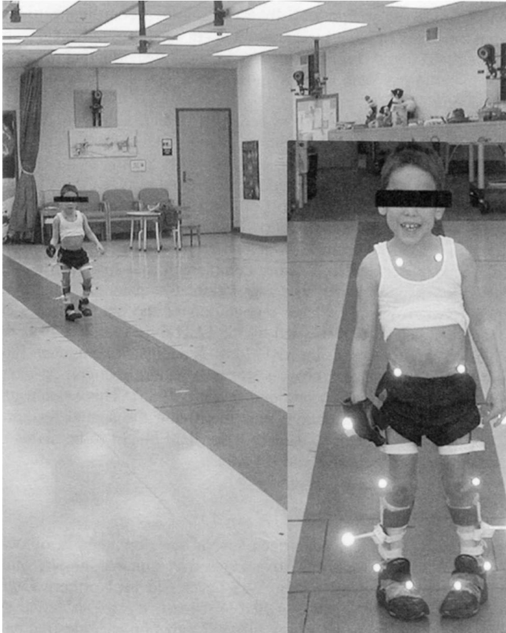
Abbildung 3.13 Gangbeurteilung eines Patienten mit Zerebralparese in einem klinischen Ganglabor. Infrarotkameras an Decke und Wänden erfassen das reflektierte Licht der auf beiden Seiten des Körpers angebrachten kugelförmigen reflektierenden Markierungen. (Mit freundlicher Genehmigung des Gait Analysis Laboratory, Connecticut Children's Medical Center, Hartford, CT.)
