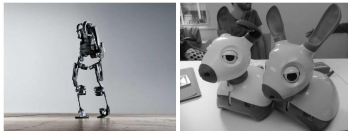
Abb. 1. Linkes Feld: „Ekso“, die Abkürzung für Exoskelett, ist ein tragbarer Roboter, der gelähmten Patienten beim Gehen hilft. Rechtes Bild: Zwei MIRO-Robotersäugetiere, ein Beispiel für einen „sozialen“ Roboter.
