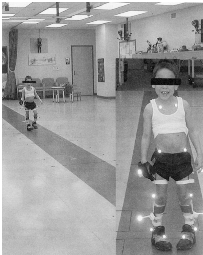
Figure 3.13 Évaluation de la marche d'un patient atteint de paralysie cérébrale dans un laboratoire clinique de la marche. Des caméras infrarouges au plafond et sur les murs captent la lumière réfléchie par les marqueurs réfléchissants sphériques montés des deux côtés du corps. (Avec l'aimable autorisation du Gait Analysis Laboratory, Connecticut Children's Medical Center, Hartford, CT.)
