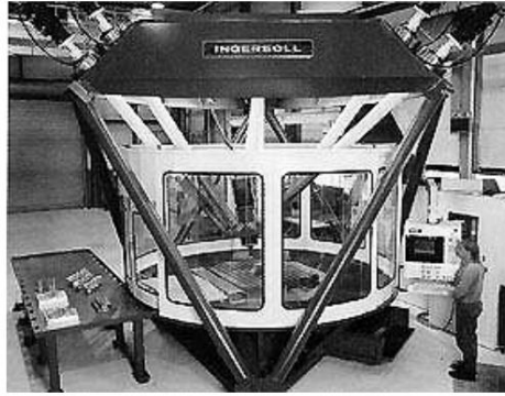
(a) Une machine-outil basée sur la plate-forme Stewart (Ingersoll Rand) 6
