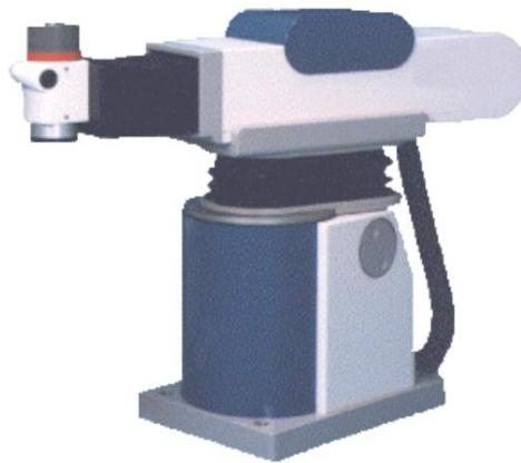
Рис. 10 Цилиндрический робот RT3300 (Seiko)
