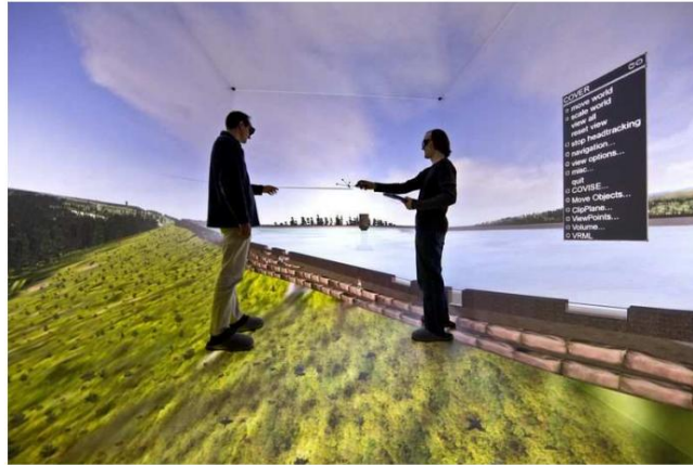
Fig. 5.3 El Entorno Virtual Automático de Cave (CAVE). El CAVE ofrece a los investigadores una completa inmersión, entorno de simulación 3-D para analizar y discutir sus cálculos. Creado por el Departamento de Visualización en el Centro de Computación de Alto Rendimiento de Stuttgart (HLRS), Universidad de Stuttgart. Cortesía de HLRS, Universidad de Stuttgart.
