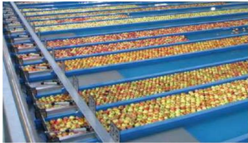
Abb. 8.2 Apfelsortieranlage der BayWa-Firma in Kressbronn und Einordnung einiger Äpfel in die Warenklassen A und B im Objektraum (Foto: BayWa)
