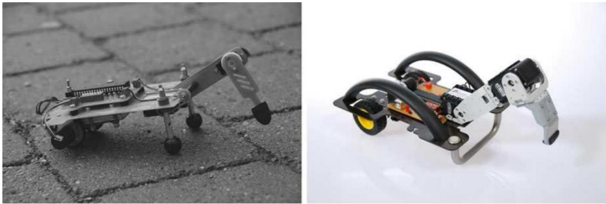
Abb. 10.10 Zwei Versionen des Krabbleroboters
