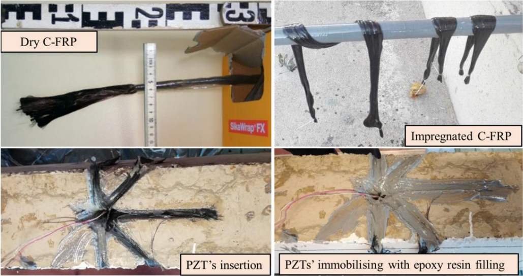
Figura 4. Inserción de los transductores PZT en los orificios perforados ensamblados con las cuerdas C-FRP.
