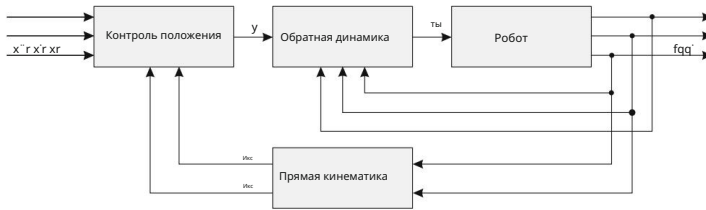
Рис. 10.14 Управление роботом на основе обратной динамики во внешних координатах с учетом контактного усилия
